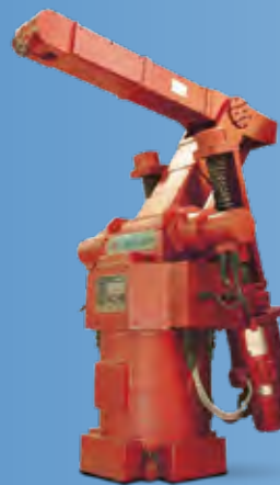
Japan's first all-electric industrial robot "MOTOMAN-L10" 1977年
